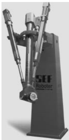
Bild 27 Roboter mit Stabkinematik, Quelle: SEF
