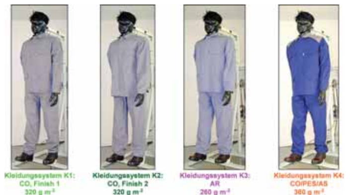
Bild 2: Konfektionierte Arbeitsschutzanzüge mit T-Shirt, Unterhemd, Unterhose, Socken und Arbeitsschuhen zu Kleidungssystemen kombiniert
