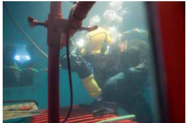
Schweißvorführung durch einen Taucher (Lichtbogenschweißen mit speziell umhüllten Elektroden)
