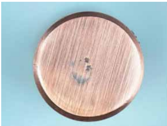
a) leichte Erosionen auf der Arbeitsfläche Elektrodenoberfläche nach 35 Intervallen
