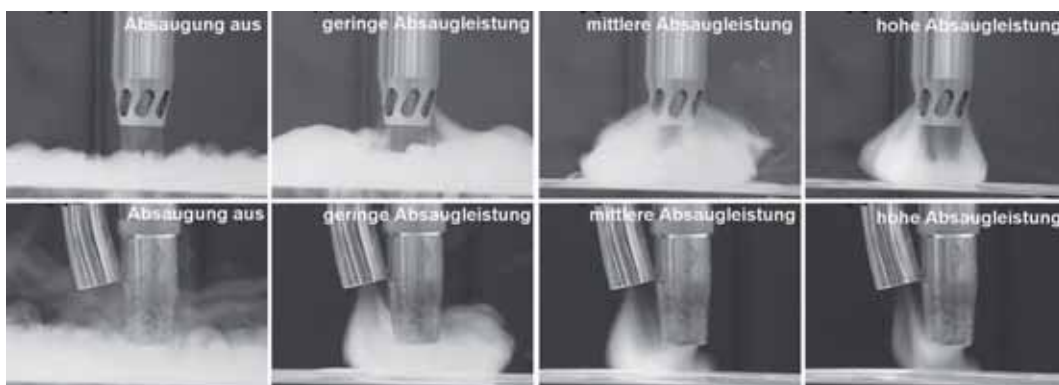
Bild 2: Visualisierung der Schutzgasströmung unter dem Einfluss der Absaugung
