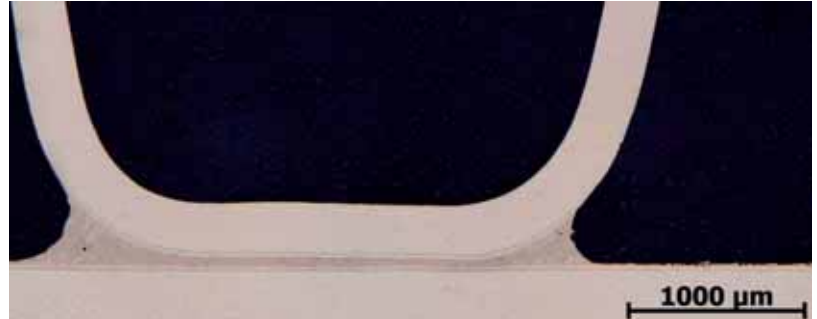
Bild 2: Metallographischer Anschliff aus der Lötnaht des Demonstratorbauteils
