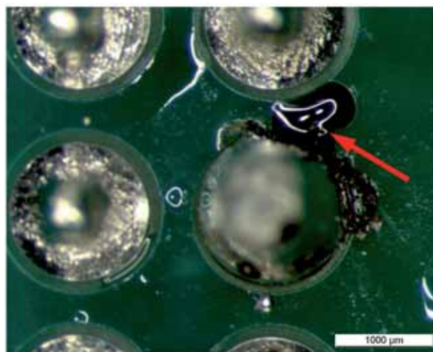
Bild 1: Optische Inspektion, Leiterplatte nach übermäßiger manueller Lötwärmebelastung
