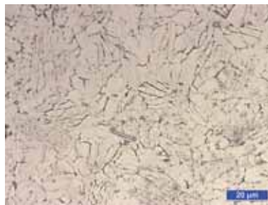
b) Fügezone reibgeschweißt – ohne Wärmenachbehandlung
