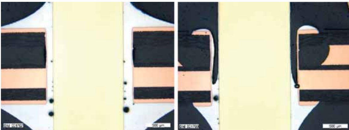
Bild 1: Lötresultate – Anschluss mit Schraube, Löttemperatur 285°C , Kupferlagendicke 400 µm (links: Wärmefalle einfach mit vias; rechts: Wärmefalle einfach ohne vias)
