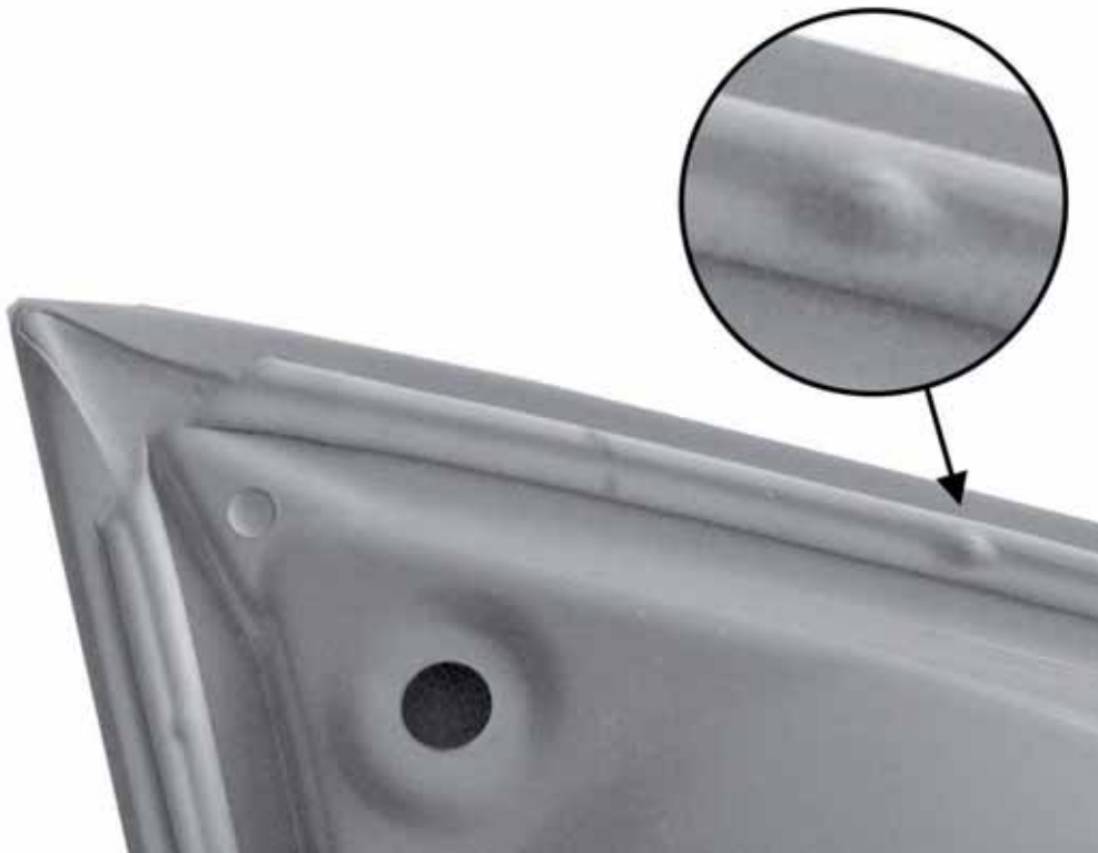
Bild 2: Industrielles Bauteil mit einer blasenförmigen Fehlstelle in der Nahtabdichtung
