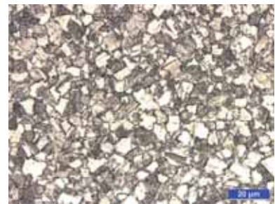
c) Fügezone reibgeschweißt - mit Wärmenachbehandlung (1240°C/1h/AC, 850°C/6h/FC)
