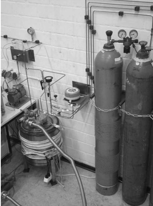
**Bild 1** - Gasdiffusions-Messplatz mit Klimakammer
