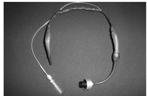
**Bild 2** - verbesserte Konstruktion mit Ohren-Nackelpolsterungen und angebautem IOM-Filterkopf
