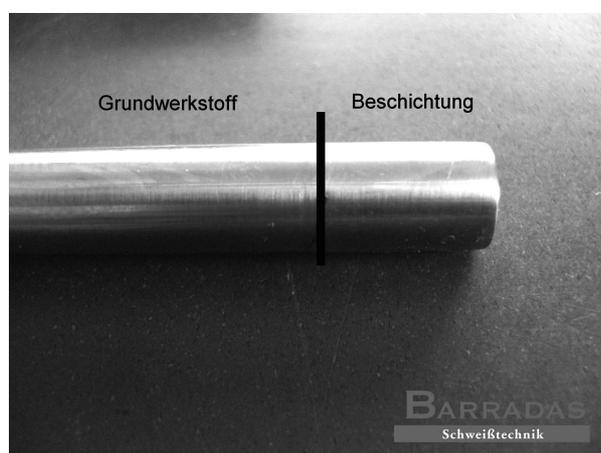
**Bild 2** - Beschichteter Auswerferstift nach Endbearbeitung
