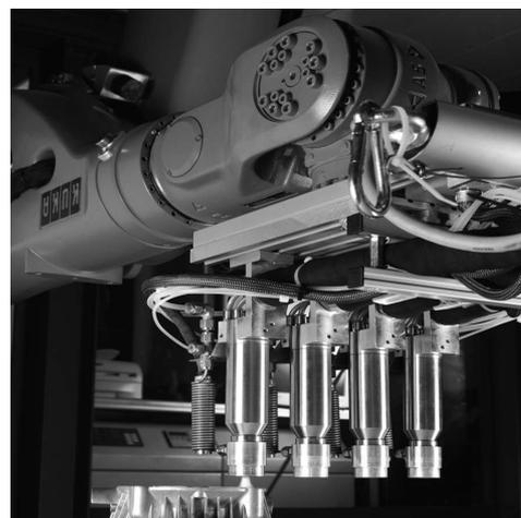
**Bild 2** - Plasmadüsen bei der Beschichtung
