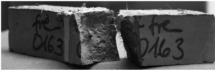
**Bild 2** - Bruch eines verklebten Prisma aus faserbewehrtem UHPC
