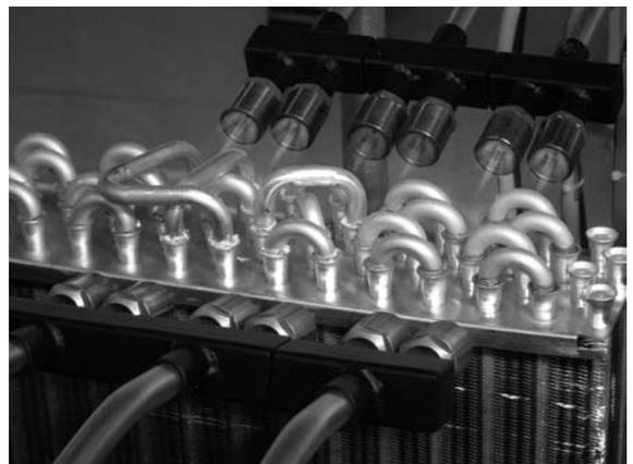
**Bild 1** - Stranggepresste Lotdrähte aus einer AlSiZn-Legierung
