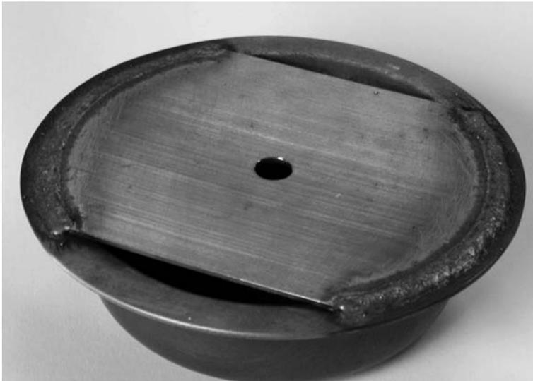
**Bild 1** - Verifikationsschweißung am Napf aus FeMn-Stahl
