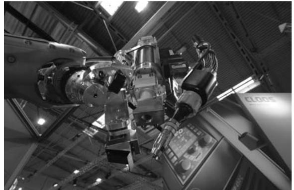
Bild 25 - Forschungsbedarf besteht weiterhin beim Roboterschweißen. Vor allem Forschungen zum Laser-Lichtbogen-Hybridschweißen mit Robotern können zukunftsweisende Anwendungen erschließen.
