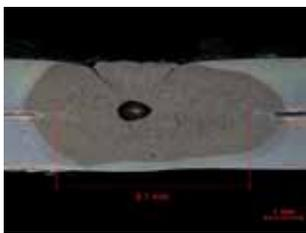
Risse im Bereich der Einprägung, Pore bzw. Lunker
