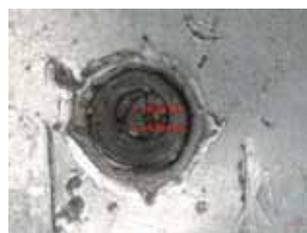
symmetrischer Ausknöpfungbruch bei optimierter Geometrie / FE = 4 kN,  $t_S = 200$  ms,  $I_S = 15,0$  kA
