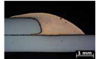
$vD/vL=3,8$ **Bild 1:** realisierbare Nahtquerschnitte
