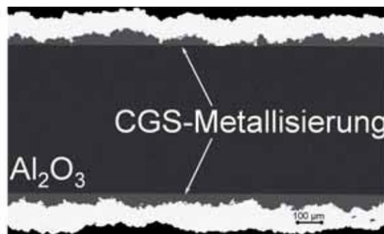
**Bild 1** - Beidseitig kaltgasgespritzte Substrate -
