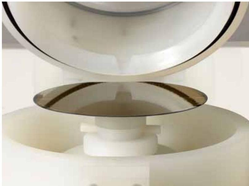
**Bild 2** - Wafer mit appliziertem Klebstoff auf dem Spincoater
