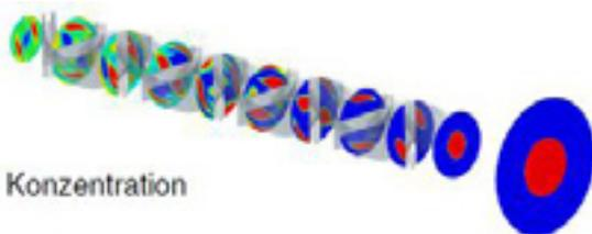
Bild 43: Verteilung der Klebstoffkomponenten im Statikmischer, CFD-Simulation [Sulzer]
