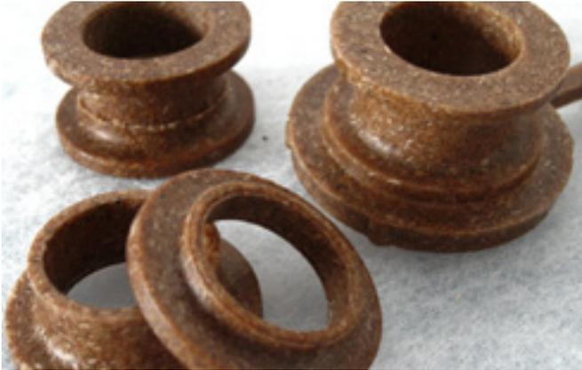
Bild 49: Zweiteiliger, geschweißter und einteiliger DVS-Probekörper aus WPC zur Bestimmung des US-Schweißfaktors
