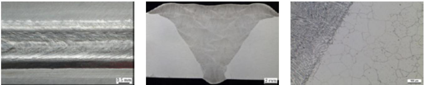
Bild 30: MAG-CMT-Schweißnaht an 12 mm dicken Blechen der Ni-Basislegierung Alloy 617 (2.4663): Nahtoberfläche (links), Lagenaufbau im Querschliff (Mitte) und Wärmeeinflusszone (rechts)
