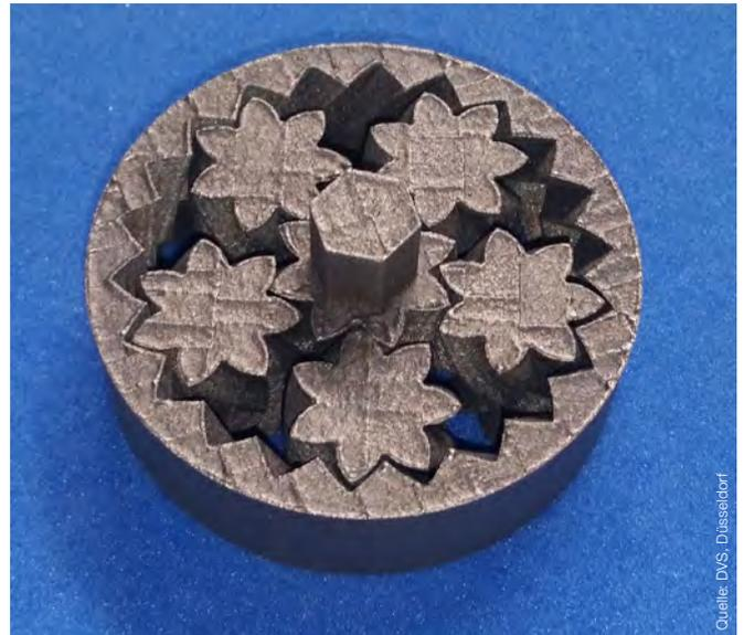
Bild 26: Funktionsbauteil (Planetengeriebe) am Stand des ifw Jena
